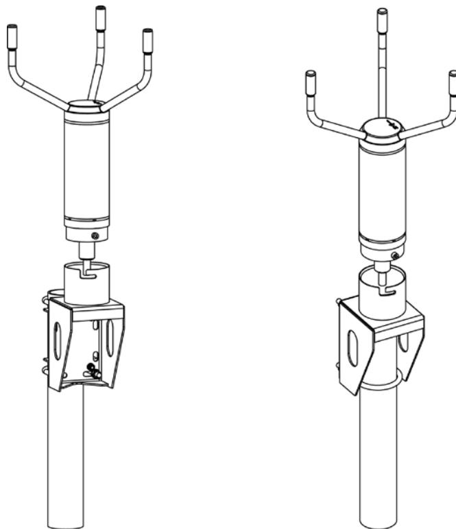
Si vous montez le WMT700 sur une traverse, le capteur de vent peut être placé avec les transducteurs vers le haut ou vers le bas. La figure suivante montre le WMT700 installé avec les transducteurs orientés vers le haut. Si le capteur de vent est installé avec les transducteurs orientés vers le bas, reportez-vous à la section Paramètres de configuration dans le Manuel de l'utilisateur.
