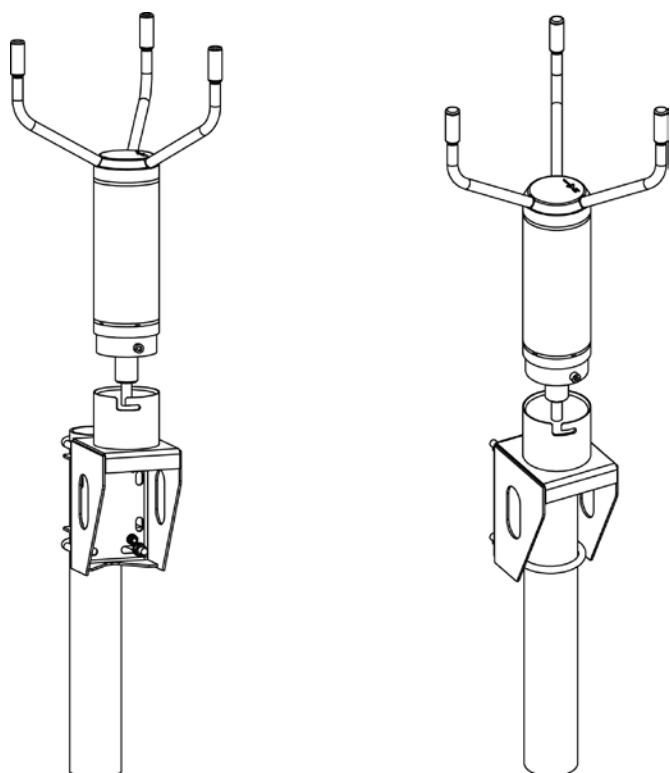
WMT700 をクロスアームに取り付ける場合、風向風速センサのアレイを上向きまたは下向きにして設置できます。以下の図に、アレイを上向きにして設置した WMT700 を示します。風向風速センサのアレイを下向きにして設置する場合は、取扱説明書の「設定パラメーター」の項を参照してください。
