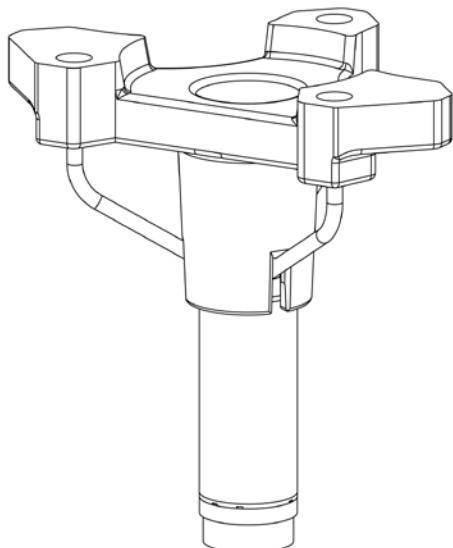
**ATTENTION** Lorsque vous manipulez le capteur WMT700, évitez de tourner, tirer, heurter, plier, érafler ou toucher les transducteurs avec des objets pointus. Le moindre impact sur le positionnement des transducteurs du capteur de vent peut endommager l'appareil.
